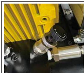
松开溢流阀上的锁紧螺母，顺时针缓慢旋转溢流调压阀，使 A 口达到目标压力
