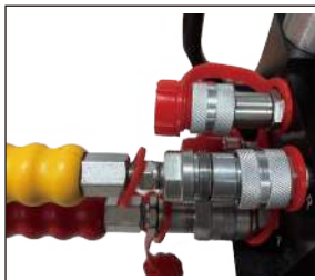
油管轴向对正完全推入出油口
