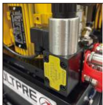
通过手柄上的电磁阀控制按钮，实现对系统油液流向的精准控制。
