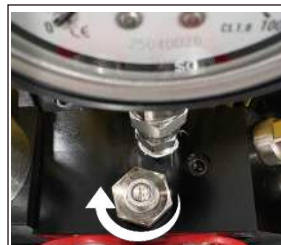
回程压力通过 R 口限压阀进行调节
