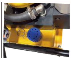
安装排气堵头
