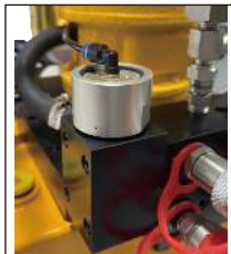
通过手柄上的气控阀控制按钮，实现对系统油液流向的精准控制。
