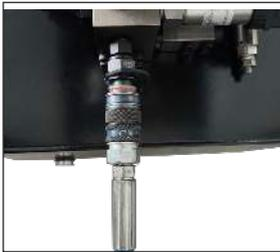
外锁环后退，油管轴向正完全推入出油口
