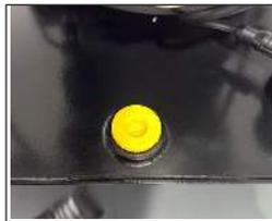
若油位低于 2/3，请将此堵头旋转取出后，进行加油操作。
