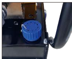
安装排气堵头
