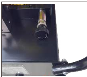
拧松锁定螺母调节溢流调压阀。
