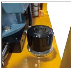
若油位低于 2/3，请将此出口口堵头旋转取出后，进行加油操作。
