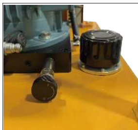
拧松锁定螺母调节溢流调压阀。
