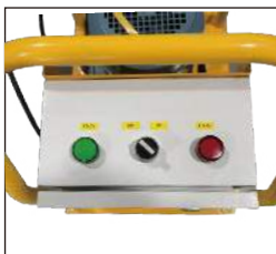
接通电源，左侧 READY 绿灯亮起，将旋转开关转至 ON 位，加压启动。
